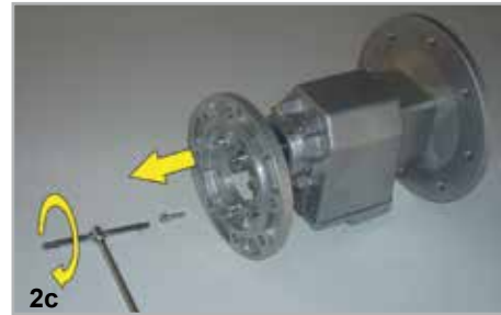
2c) Remplacer la bride et revisser les vis de fixation (voir le tableau).
