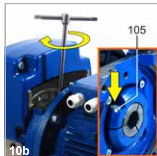
10b) Desserrer la vis 105 du joint pour le serrage de l'arbre du moteur.
